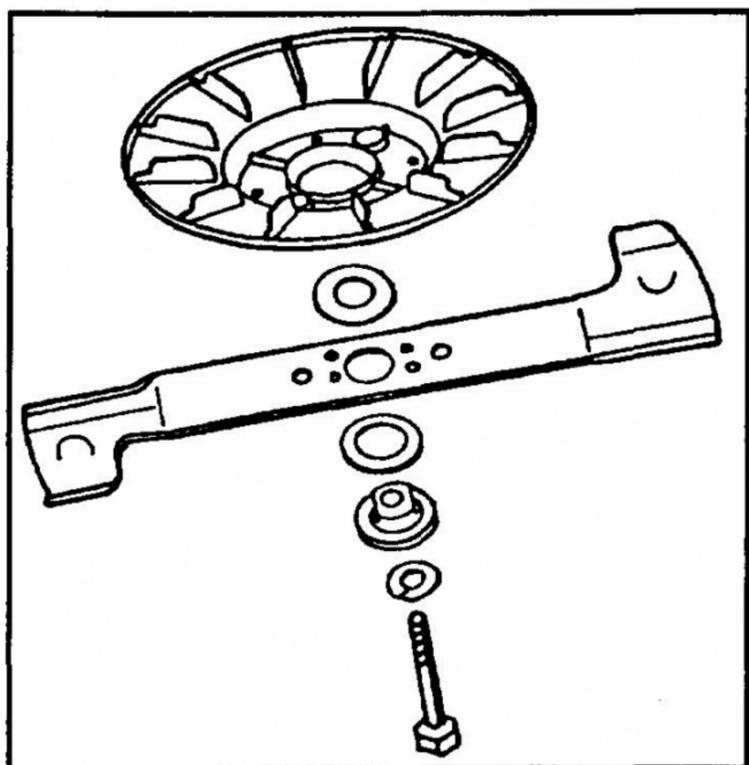
2. **Messerbalken und Lüfterrad demontieren.**
