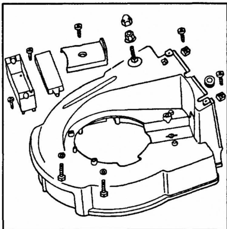
3. **Chassis, Batteriekasten, Keilriemenabdeckung, sowie Flachrundschrabe mit Mutter und Verschlusskappe demontieren.**
